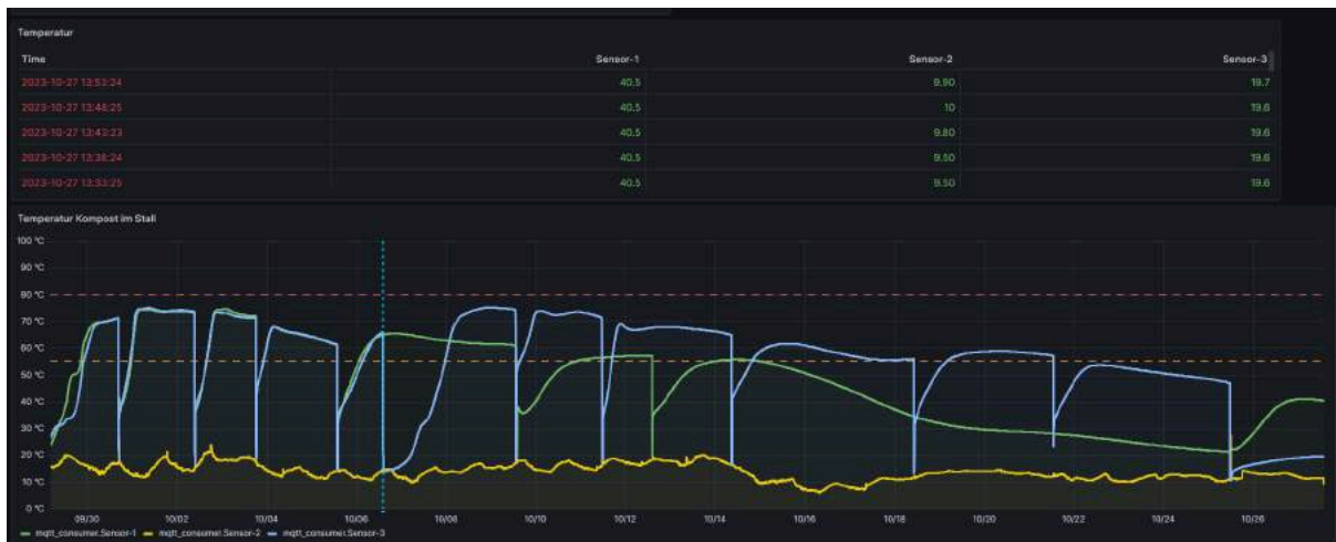
Temperaturentwicklung der Daten aller drei Sensoren, übertragen per LoRaWAN, visualisiert in Grafana (grün und blau = zwei unterschiedliche Komposte, gelb = Umgebungstemperatur)
