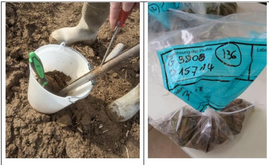
Abbildung 7: Zusammenführung der vier Teilproben zu einer repräsentativen Punktprobe durch Vermischen im Probeneimer und anschließende Verpackung mit dreifacher Beschriftung.
