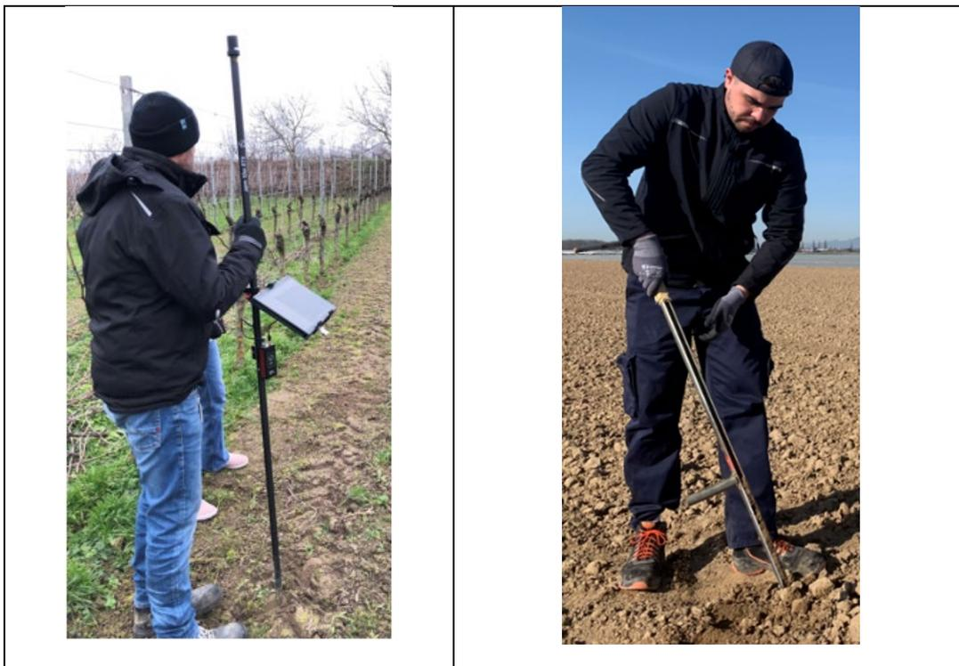
Abbildung 6: GPS Antenne zur Auffindung der Geoposition der kartierten Messpunkte (links) und Entnahme der Bodenprobe in 0-30 cm Tiefe mit einem Pürckhauer Bohrstock (rechts).
