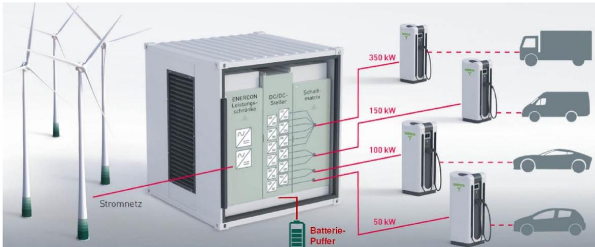
Abbildung 1: modulierbares Ladesystem der Fa. Enercon
