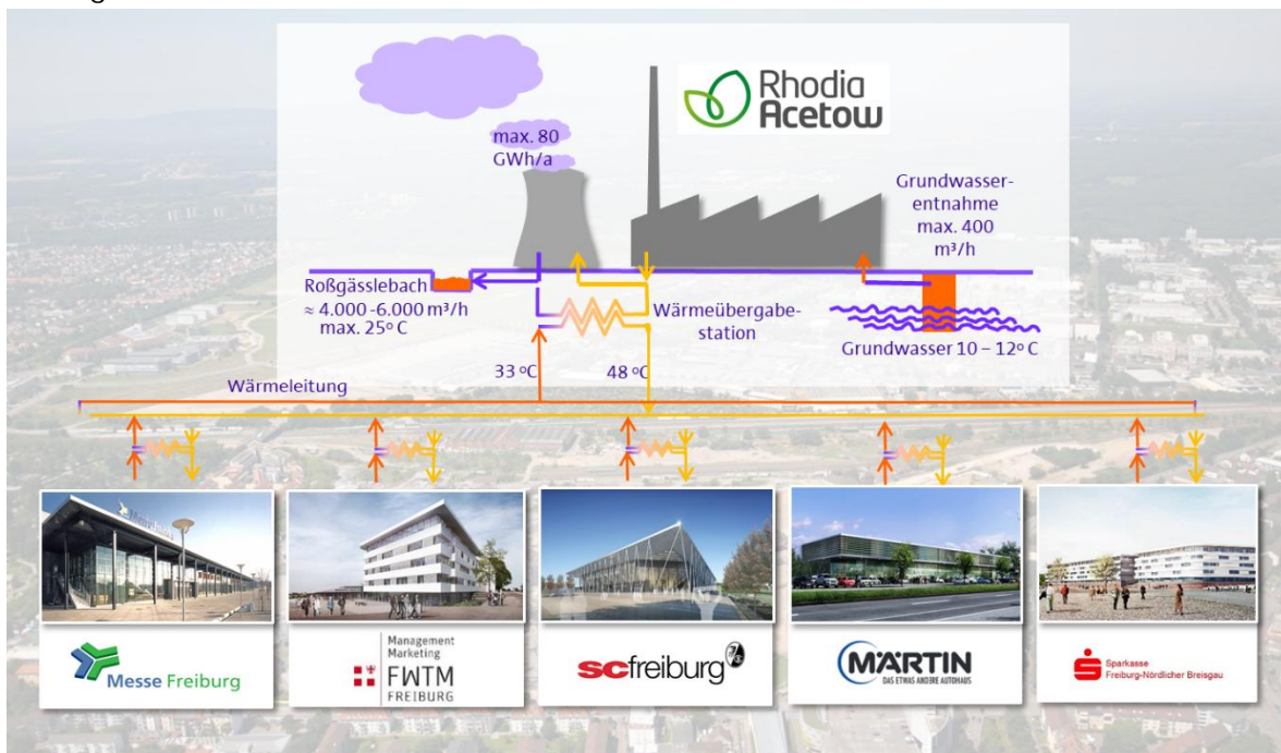
Abb. 1 „Systemerläuterung Abwärme Quelle bei der Cerdia“
