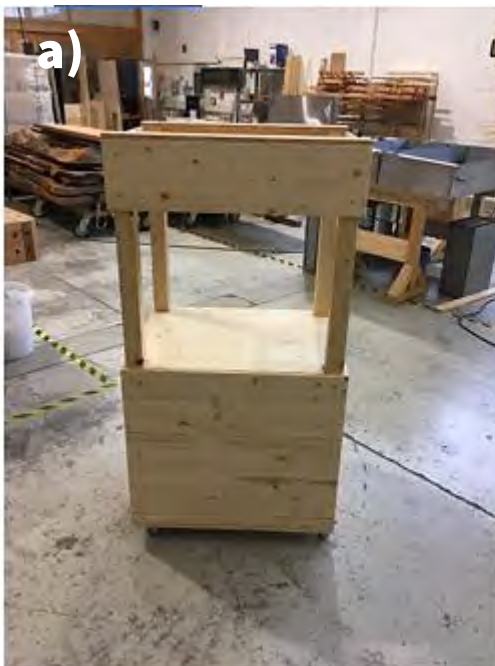
Abbildung 49: Holzkonstruktion für den Aquaponik-Prototyp, a) mit geschlossener Tür, b) mit geöffneter Tür
