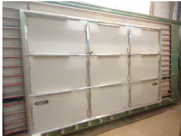
Abbildung 26: Schablone für Rahmenkonstruktion
