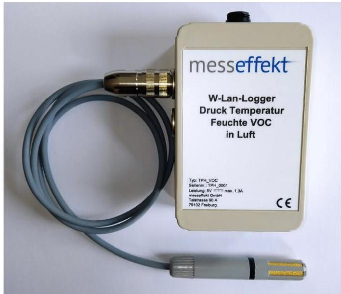
**Abbildung 4: von messeffekt entwickelte Messbox zur Erfassung der Luftparameter. Der abgesetzte Sensor erlaubt eine Messposition unabhängig von der Box-Position z.B. bei beengten Messpositionen wie Bohrungen in Lüftungskanälen. Zusätzlich zum Batteriebetrieb ist eine externe Stromversorgung für eine Dauermessung (oben an der Box) möglich.**
