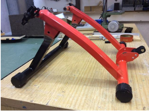
Abb4.: links: gekürzter Rollentrainer noch ohne Generator
