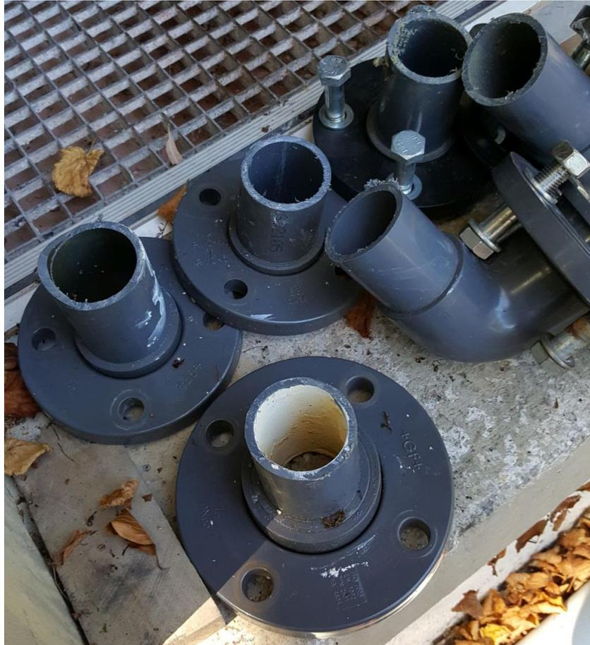
**Bild 8.4:** Demontierte Leitungen der Pilotanlage nach 8 Monaten Betrieb, Kalkablagerungen lediglich in der Leitung mit unfiltriertem Kalkwasser zwischen Ansatzbehälter und Membran (vorn): Bild: bnNETZE GmbH (2016)
