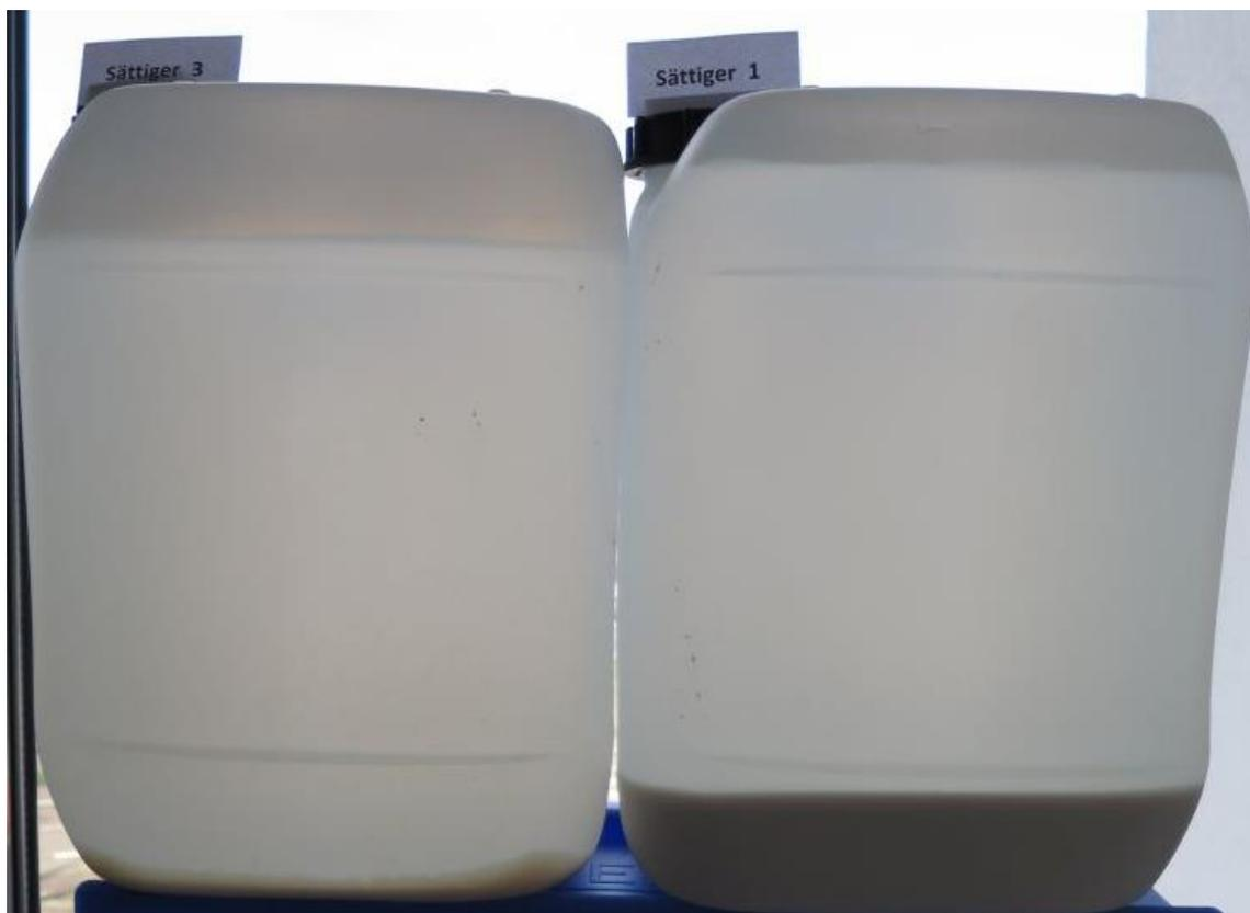
**Bild 7.5: Sedimentanfall beim Abschlammen von Sättiger 3 (links) und 1 am 23.02.16**
