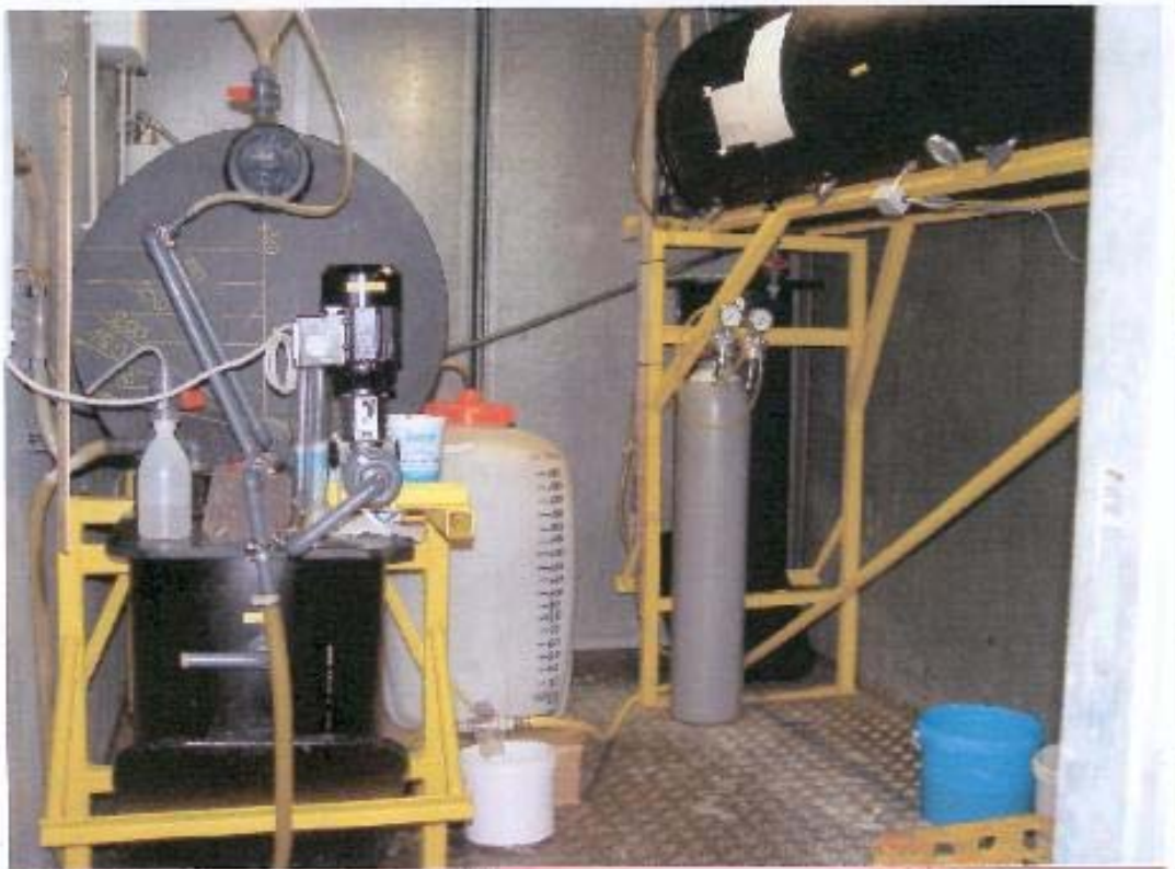
Fig. 2: Teilansicht Pilotanlage MENAG AG (Anordnung der Anlagekomponenten im Innenraum des Containers). Rechts oben: Hauptgärtank, rechts hinten (hinter Druckgasflasche): Dekanter 1, links Mitte Aufsicht Nachgärtank, im Vordergrund links: Dekanter 2. Weißer Tank hinten in der Mitte: Auffangtank Ablass Gärlösung.
