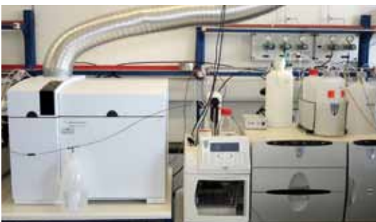
Anlage zur Untersuchung des Chromatgehalts im Wasser.
