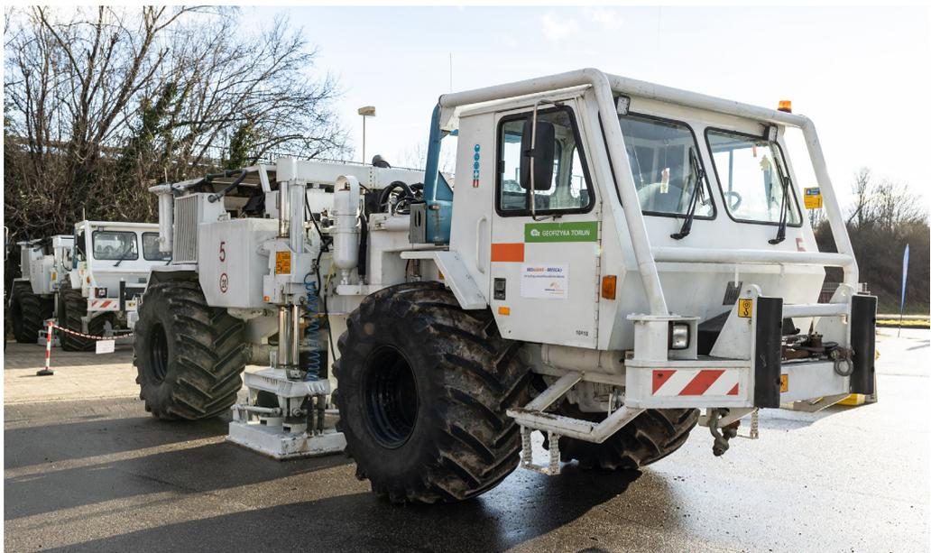
Impulsfahrzeug der 3D-seismischen Messungen.
