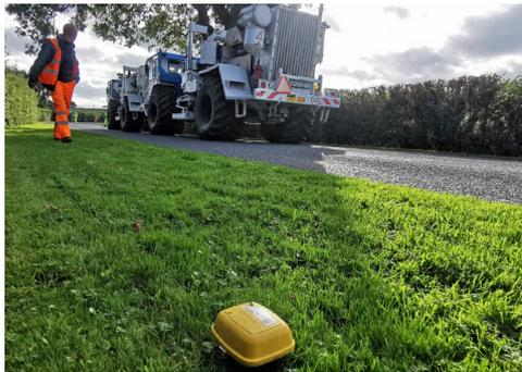
Ein gelbes Geophon misst die Schallwellen des Impulsfahrzeugs (hinten).
